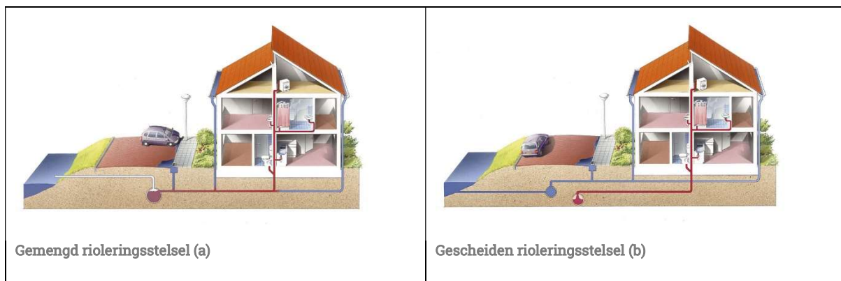
Figuur 1: Gemengd (a) en gescheiden (b) rioleringsstelsel
