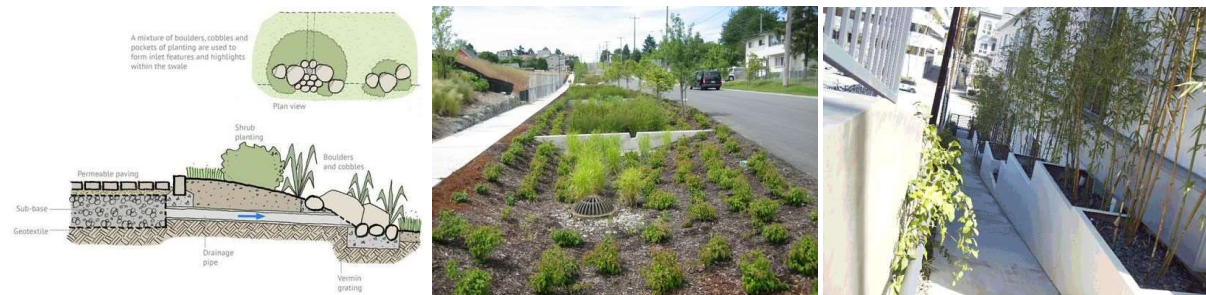
Figuur 7: Drie principes die passen in een watervoerende straat met lage verkeersbelasting. Van links naar rechts: een parkeerstrook met snelle infiltratie naar een poreuze koffer (bemerkt de afwaartse boordsteen om oppervlakte stroming te voorkomen); een doorlopende groenstrook met drempels; en een stijl steegje waarin een gelijkaardige situatie werd gecreëerd met een opeenvolging van plantbakken.
