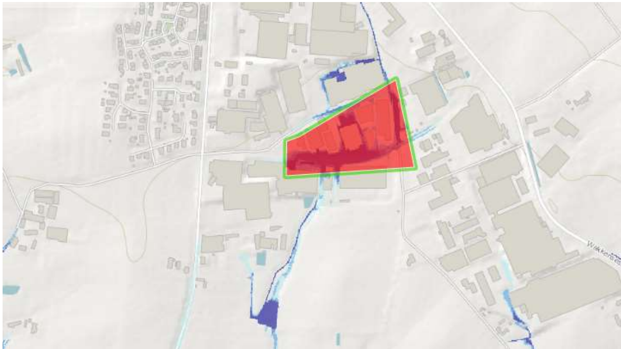
Figuur 34: Detail van de pluviale overstromingskaart waarop de depressie resulteert in wateroverlast. De rode figuur geeft aan dat Tielts hier een opmerking heeft bij gemaakt (in dit geval dat de overlast niet voorkomt in de praktijk)
