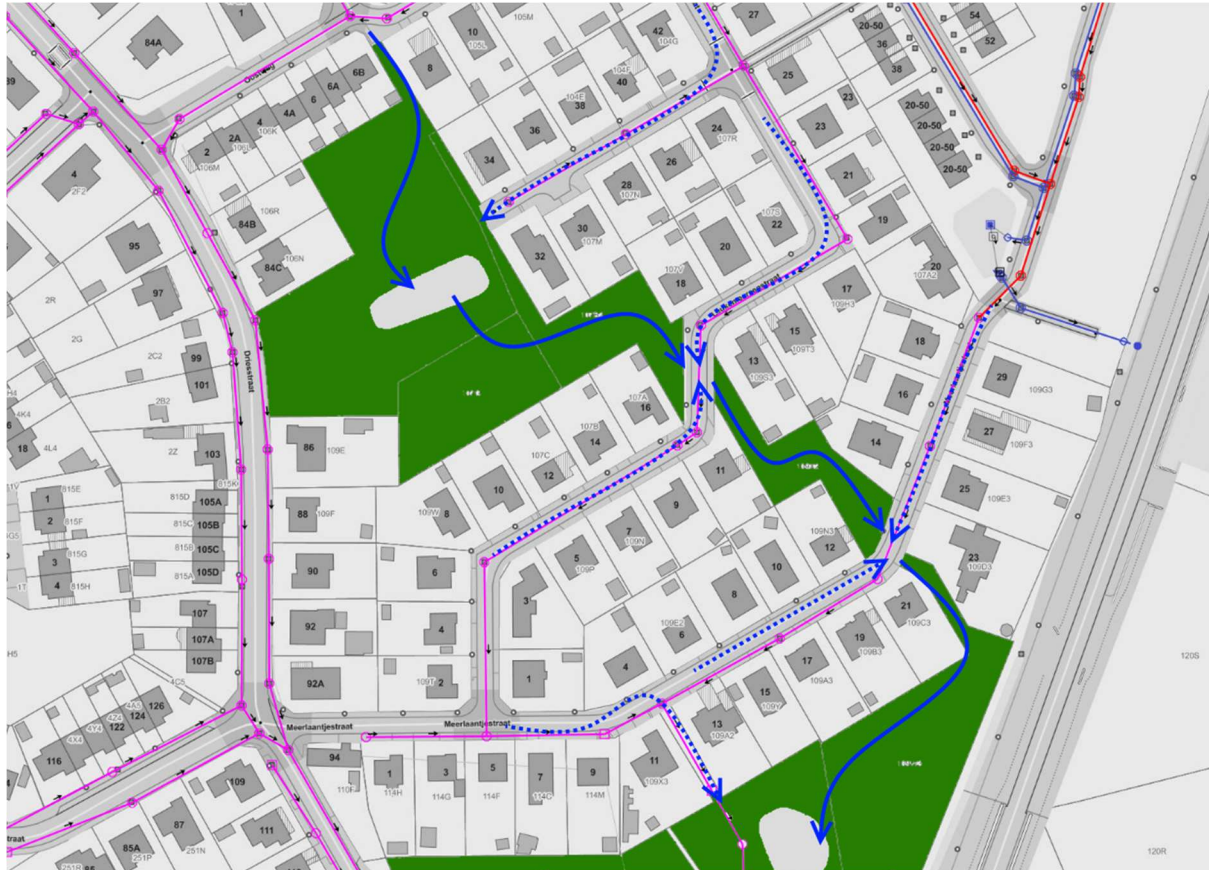
Figuur 25: Detail van de aaneenschakeling van groenzones met in vol blauw de hoofdstroomrichtingen van een gracht of aaneenschakeling van wadi's, in stippellijn de straat infrastructuur (leidingen of kanaaltjes)
