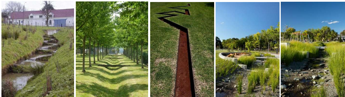
Figuur 11: Groenblauwe afvoerwegen bieden een breed spectrum aan inrichtingsmogelijkheden. Van links naar rechts: een gracht met kunstmatige meandering om te vertragen, een lanen-vormig infiltratiekanaal, een zeer strak vormgegeven meandering en twee beelden van een waterspeeltuin waar afhankelijk van de waterstand delen rond de speeltuin zich vullen of de speeltuin mee overstroomt.
